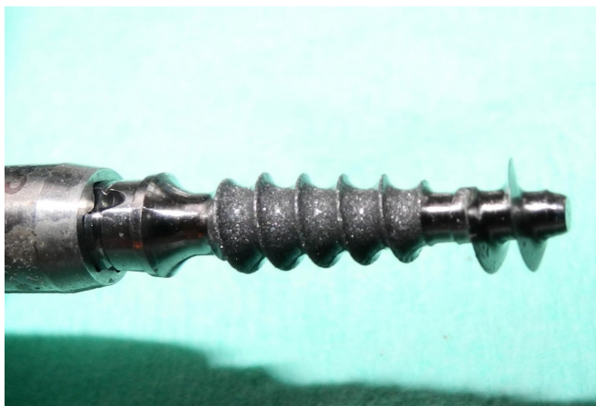
Figura 2. Implante dual “dos roscas en un tornillo”. Rosca con superficie lisa en el ápice y rosca de compresión con superficie rugosa en el cuerpo del implante hasta el área crestal.
